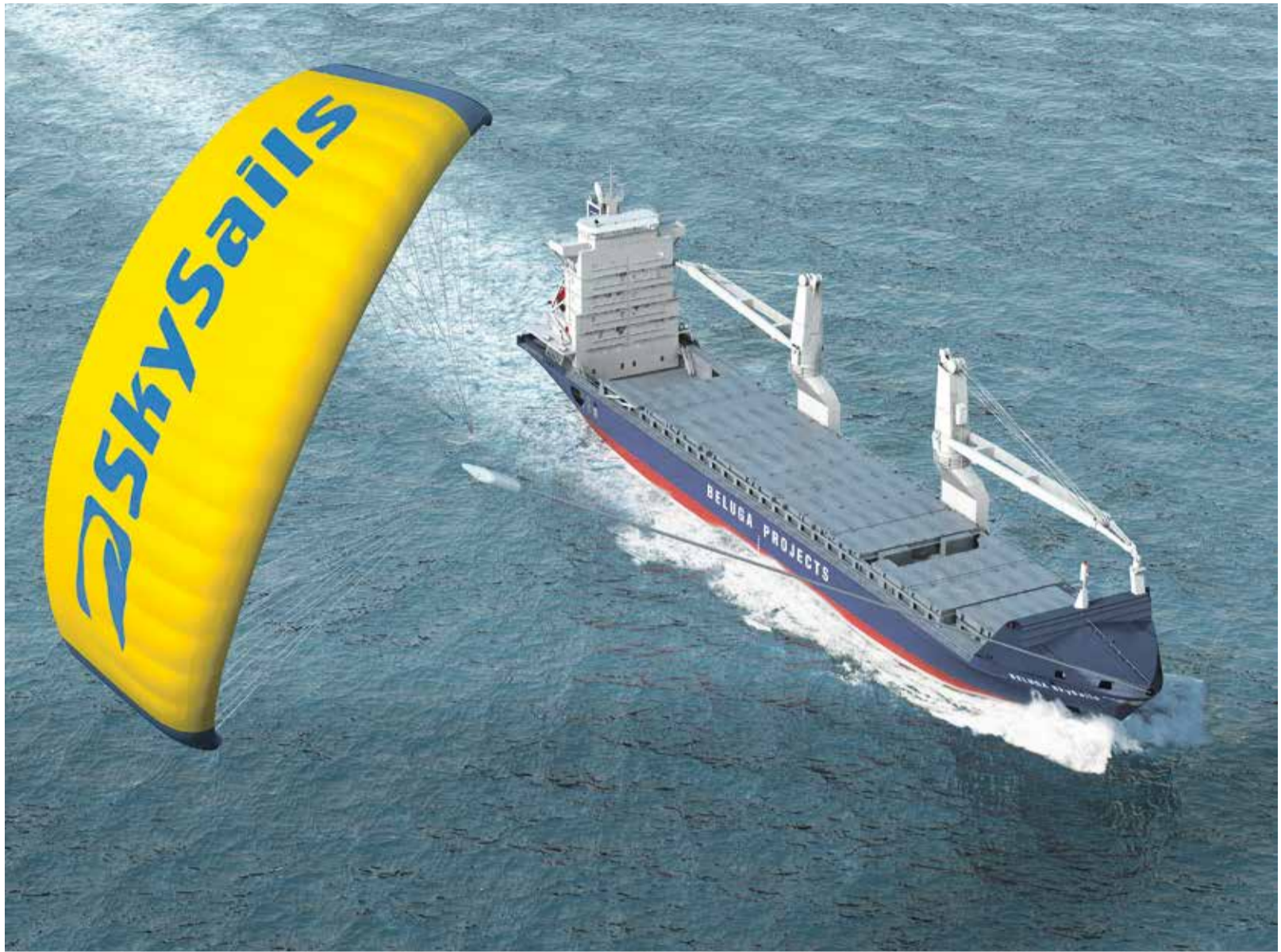
Nutze den Wind, um über die Weltmeere zu schippern: Das Containerschiff „MS Beluga Sky Sales“ mit großem Gleitschirm Foto: Skysails/dpa
